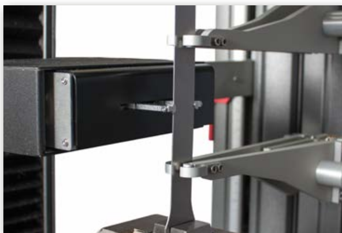
O AutoXBiax centraliza automaticamente no comprimento base pré-definido
