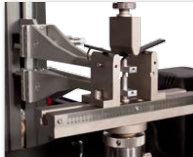
Uso do AutoX750 para medir a deformação por flexão
