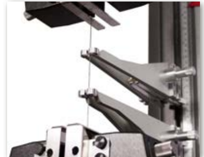
Cordão de fibra de carbono em garras pneumáticas de ação lateral com AutoX750
