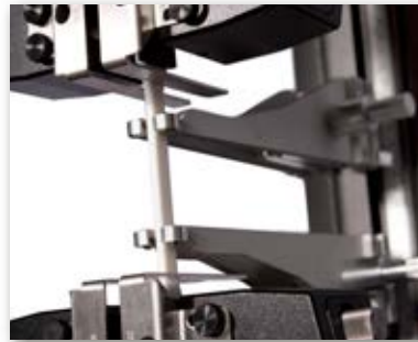
Ensaio de tração de plástico com AutoX750 em uma estrutura eletromecânica
