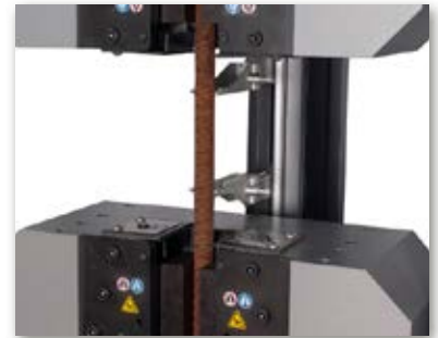
Ensaio de vergalhão com AutoX750 em uma estrutura hidráulica 1500KPX
