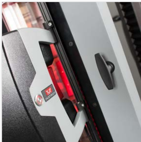
AVE 2 montado em uma câmara de temperatura
