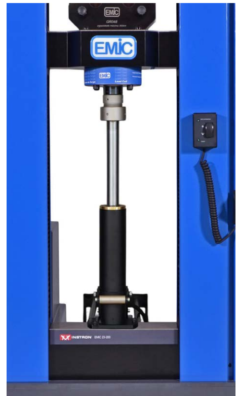
Detalhe de montagem do Dispositivo numa Máquina Universal da Série 23
