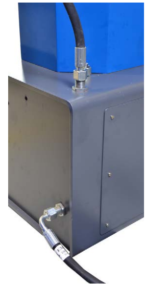
Detalhe da Entrada de Óleo na Estrutura de 2000 kN
