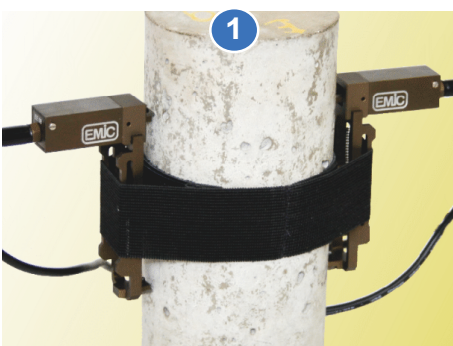
Instrumentação Eletrônica da Série 23 permite uso de 2 canais de deformação simultâneos
