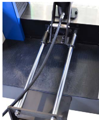
Sistema de recuo do Dispositivo para parte traseira da Máquina Universal quando não em uso.
