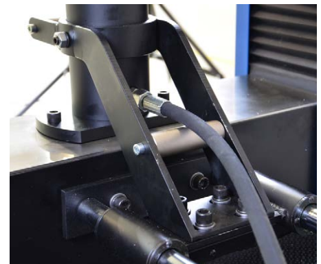
Saída de óleo do Dispositivo para ser acoplado na entrada de óleo da Estrutura de 2000kN.
